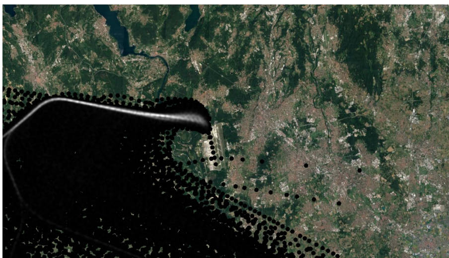
Figura 11, Mappa di concentrazione delle battute ADS-B per SID su RDL 278
